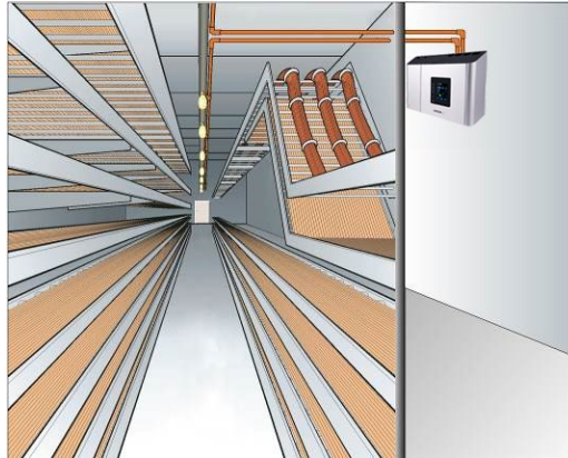
图 15: VESDA 探测器保护电缆隧道示例
