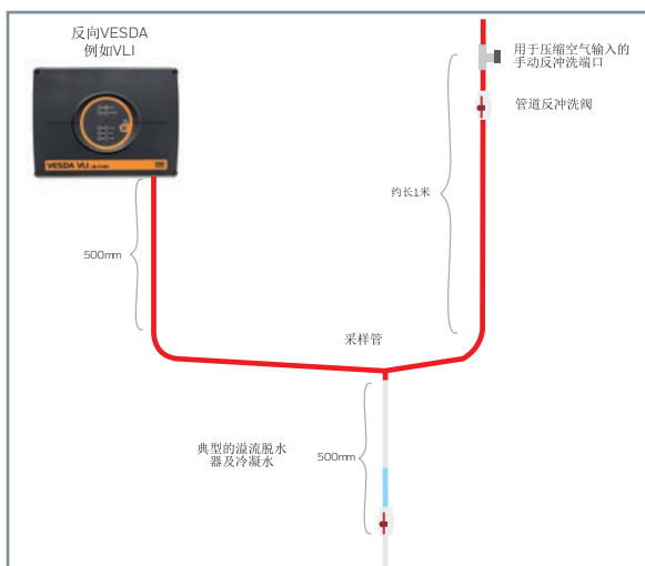
图3 - 典型脱水器布置
