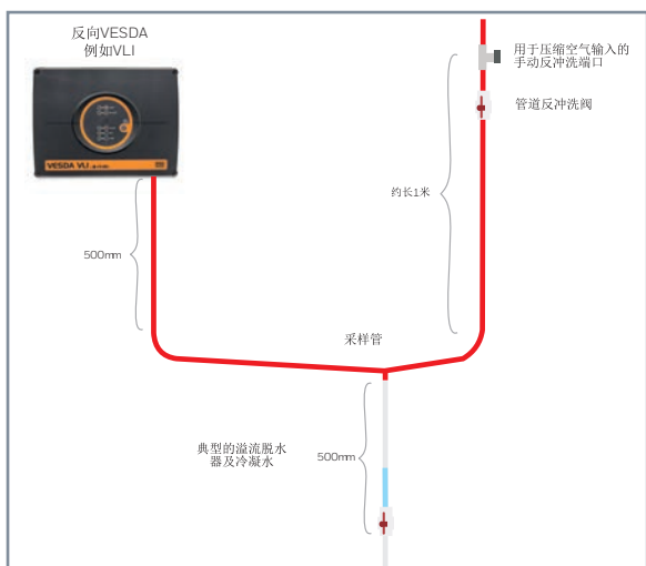
图3 - 典型脱水器布置
