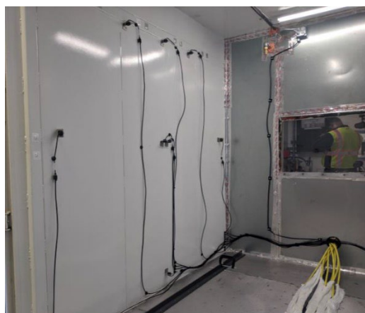
图 8：大规模消防测试壳体，配备数个传感器
