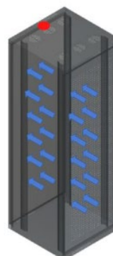
图2：监测传感器布置在电池架上方 - 安装在墙壁上
