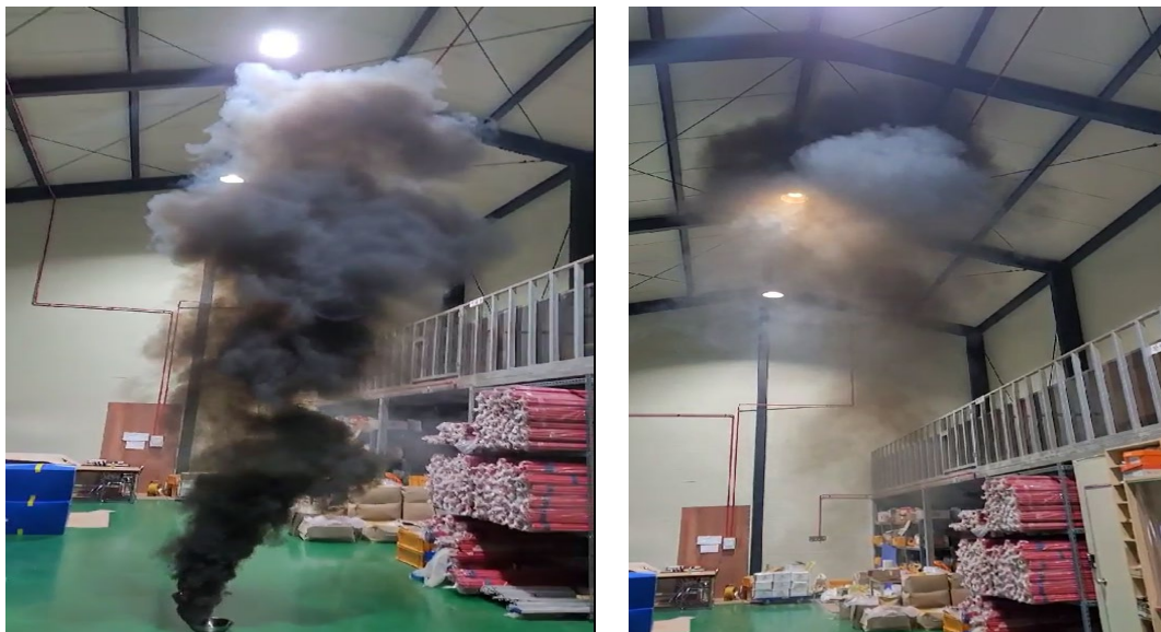
图 3：在 WINETCH 仓库内执行烟雾测试
