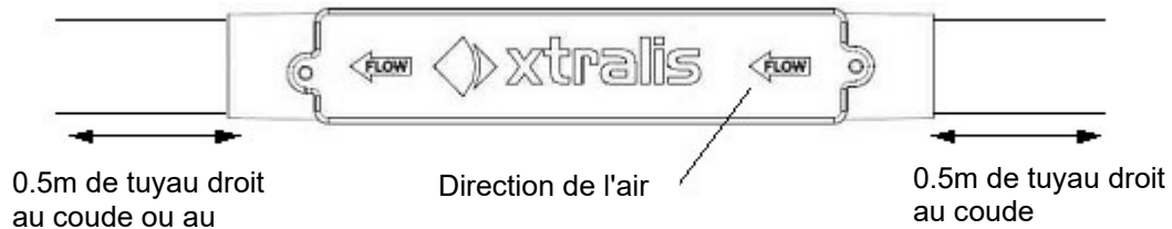
Figure 2: Filtre en ligne Xtralis (Vue de dessus) – Installation horizontale
