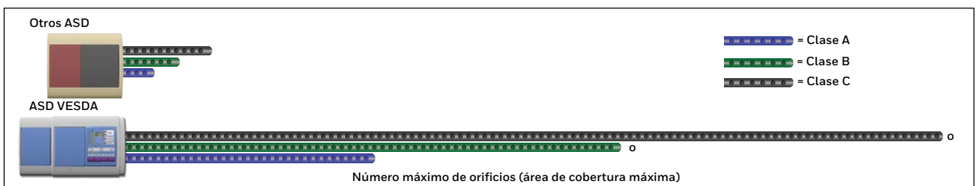
Figura 1 - Un detector superior cumplirá los requisitos de sensibilidad de cada Clase y proporcionará detección en una superficie mayor.
