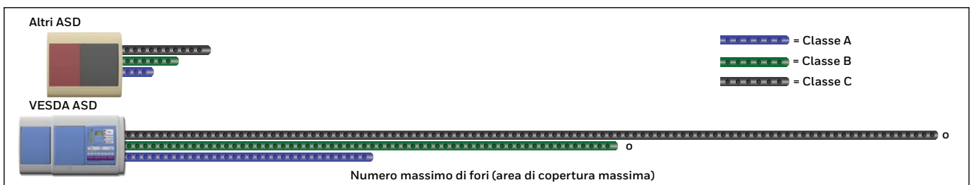
Figura 1 - Un rivelatore di qualità superiore soddisferà i requisiti di sensibilità di ogni classe, garantendo una maggiore copertura.
