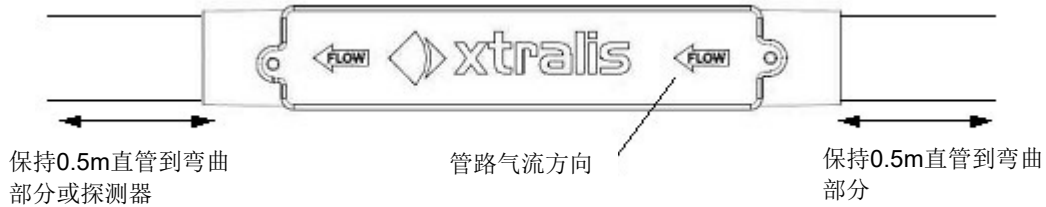
图2: 艾克利斯(Xtralis)外置过滤器（俯视图）- 水平安装
