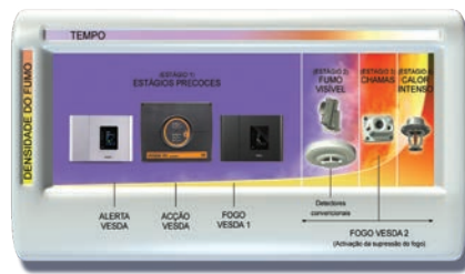
Fig 1. O produto VESDA pode ser configurado para gerar alarmes múltiplos durante o estágio incipiente de um incêndio. Os múltiplos níveis de alarme podem ser configurados para iniciar uma resposta apropriada.
