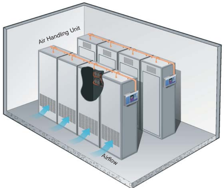
Fig 4. Muestreo capilar en gabinetes de conmutación
