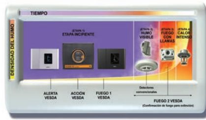
Figura 1. El detector VESDA puede configurarse para generar múltiples alarmas durante esta etapa incipiente de un incendio. The multiple alarm levels can be configured to initiate an appropriate response.
