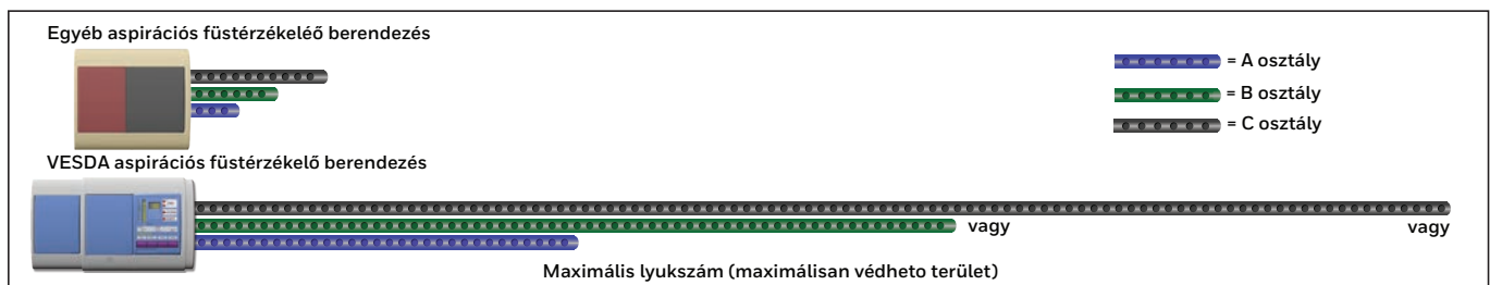
1. ábra – Egy kiváló érzékelő az összes osztály érzékenységi követelményeit kielégíti és nagy területet képes védeni.
