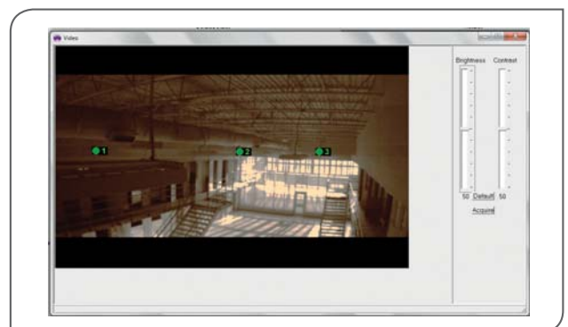
Vue réelle du récepteur indiquant par des icônes la position des différents émetteurs dans son champ d'observation
