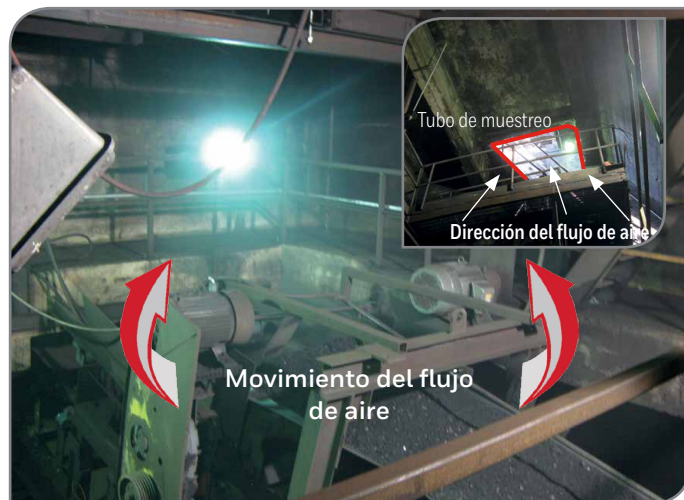
Figura 4 - Ubicación del tubo de muestreo para capturar el movimiento del aire/humo ascendente en el área polvorienta
