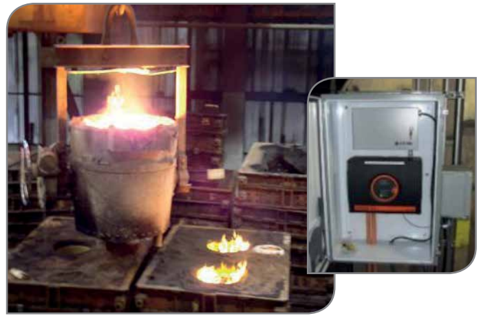
Figura 5 - DHA protegida del calor extremo
