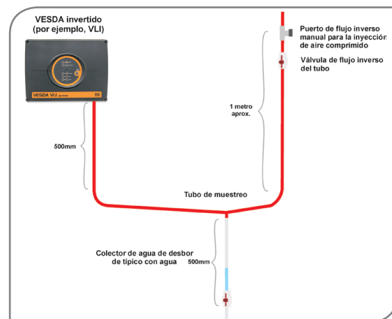
Figura 3 - Instalación típica de una trampa de agua
