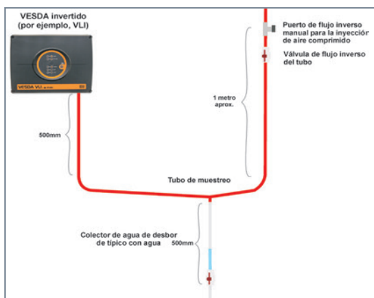
Figura 3 - Instalación típica de una trampa de agua
