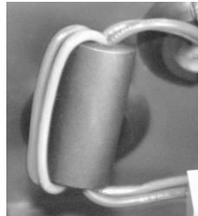
Abbildung 2-5: Ferritkern und Akkuverdrahtung
