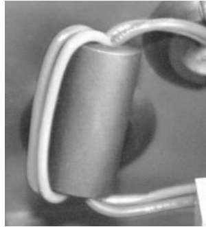
Abbildung 3-2: Ferritkern und Akkuverdrahtung
