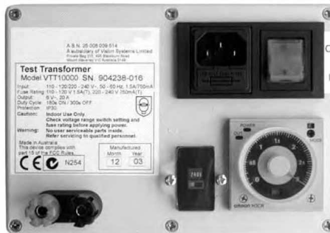
Abbildung 5-3: Prüfkoffer VTT-10000 für Kabelbrände
