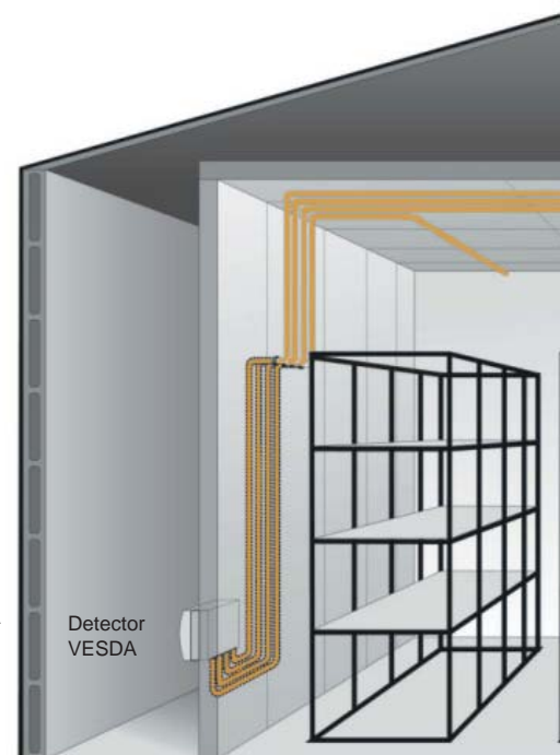
Figura 3. Detector VESDA ubicado externamente respecto al área protegida
